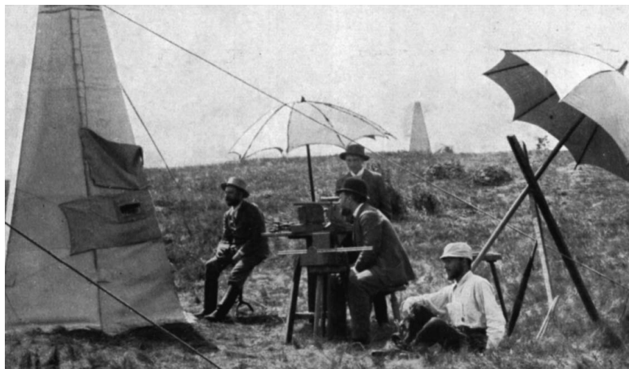
14. ábra. Gravitációs mérés a szabadban, a Ság-hegyen (1891). A vászonsátorban elhelyezett torziós inga állását távcső segítségével Eötvös Loránd észleli. Mögötte Tangl Károly egyetemi hallgató áll, a földön Kövesligethy Radó csillagász, a széken Bodola Lajos geodéta ül.
