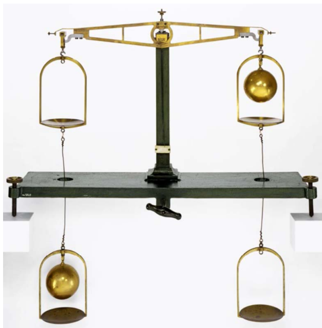
7. ábra. Jolly laboratóriumi kettős mérlege.
